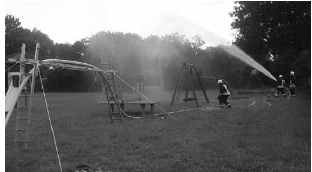
Unter einer solchen Schlauchbrücke können Pkw während eines Feuerwehreinsatzes ungehindert hindurchfahren.
